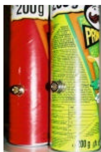
Fig. 3. Antenas montadas en un envase vacío de Pringels.
