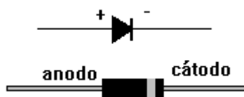
Figura 8 : Marcación de Polaridad en los diodos
