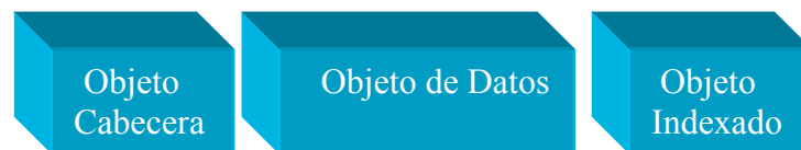
Figura 3: Partes de un fichero .asf típico.
