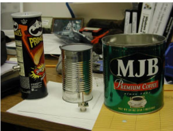
Fig. 8. Otro ejemplo de "hágaselo usted mismo". Antenas montadas en envases de distinto tipo.
