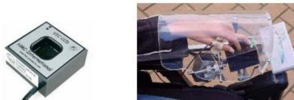
*Figura 1.14: Joystick de control por dedo*
