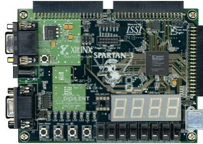
*Figura 4.3: Imagen de una FPGA modelo Spartan-3 de Xilinx*
