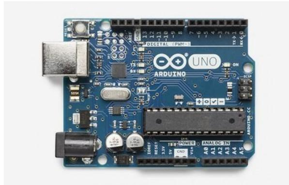
Figura 3.2: Imagen real del Arduino Uno
