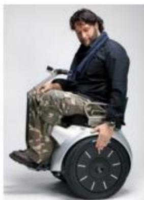
*Figura 1.7: Segway adaptado*
