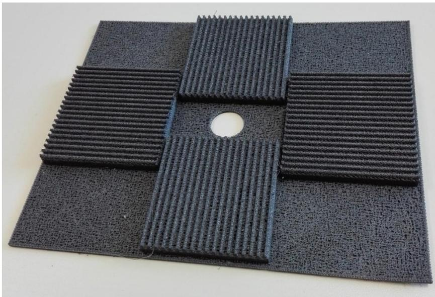
*Figura 3.18 a: Vista de la superficie inferior de la primera plataforma donde engranan los motores*
