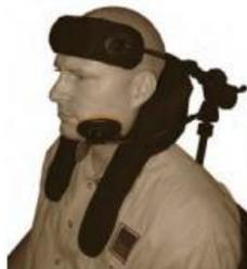
*Figura 1.20: Ilustración de pulsadores de libre de colocación*
