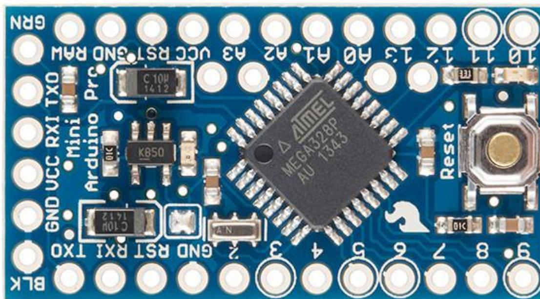
Hay que mencionar que esta tarjeta cuenta con dos versiones: una que opera a 5 V a una frecuencia de 16 MHz y otra que opera a 3.3 V a una frecuencia de 8 MHz, ambas programables y energizadas por medio de un programador o cable FTDI. La elección entre una Pro Mini de 5 V o una de 3.3 V dependerá de las características del proyecto que esté realizándose.
