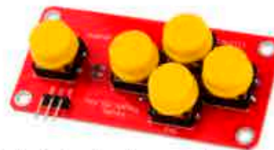
Módulo teclado que le permite utilizar un puerto analógico de leer los cinco estados clave, para Arduino
