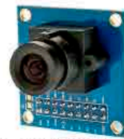
El módulo consta de una cámara de resolución 640 x 480 pixeles (VGA) equivalente a 0.3 megapixeles. (Procesamiento Digital de Señales).
