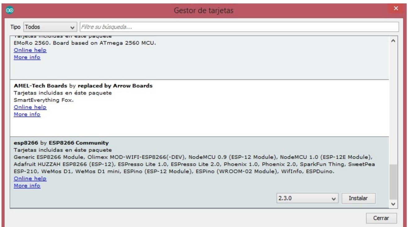
La instalación va a demorar un poco, al finalizar, el ítem del ESP8266 les debe marcar como instalado.
