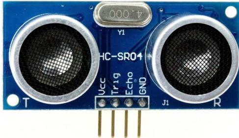
Este sensor en concreto tiene un rango de distancias sensible entre 3cm y 3m con una precisión de 3mm.
