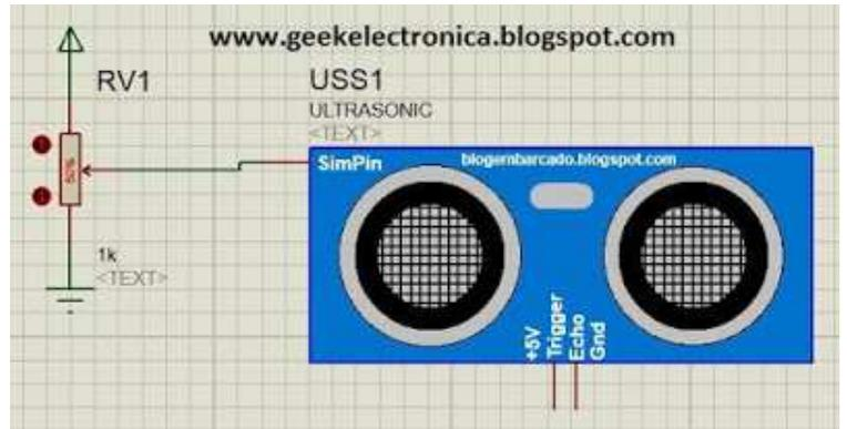
Este modelo de sensor está construido a partir de un microcontrolador que contiene internamente y es el que recibe la variación de voltaje del potenciómetro con lo que se indica una variación de distancia, los otros dos terminales que tiene este sensor deben ser conectados a la tarjeta arduino, microcontrolador o cualquier dispositivo con el que se vaya a completar el proyecto.
