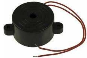
Los **buzzer activos**, en ocasiones denominados zumbadores, son dispositivos que generan un sonido de una frecuencia determinada y fija cuando son conectados a tensión. En oposición, los **buzzer pasivos** necesitan recibir una onda de la frecuencia.
