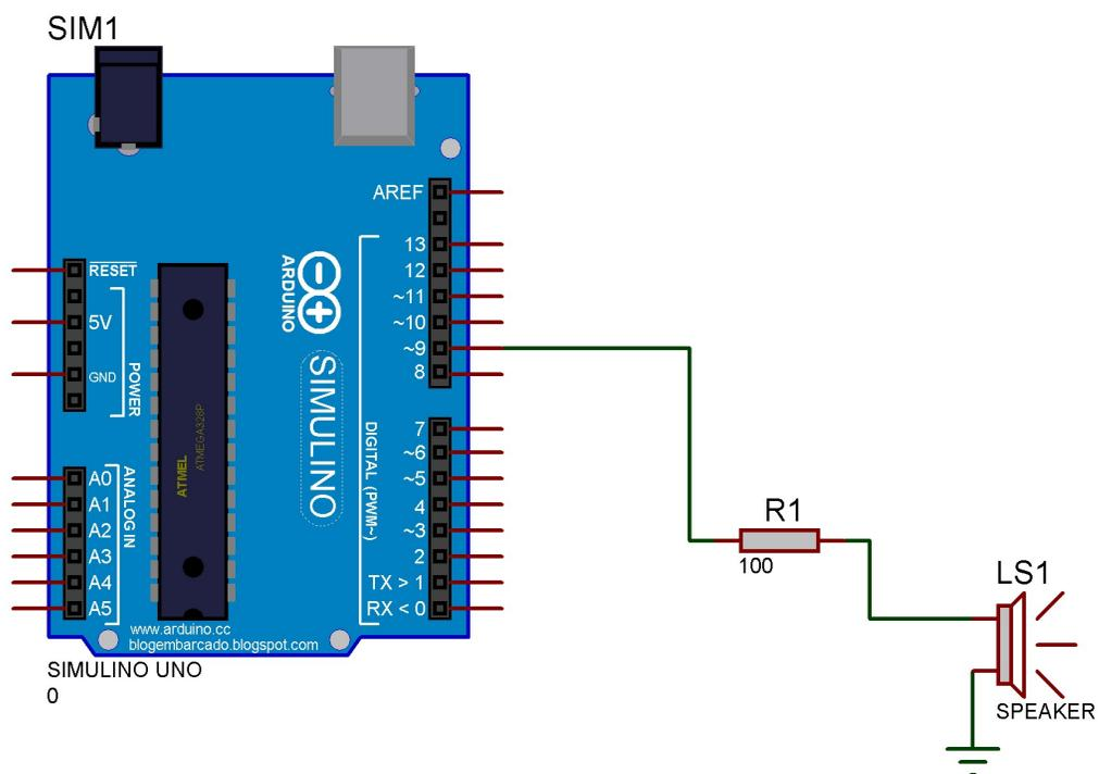
Como el Buzzer pasivo es del tipo piezoelectrico y por lo tanto tiene una impedancia alta, el SPEAKER que usamos en Proteus le damos una impedancia de 1K- La resistencia de 100 ohms es solo una proteccion por si se cortocircuita el Buzzer.
