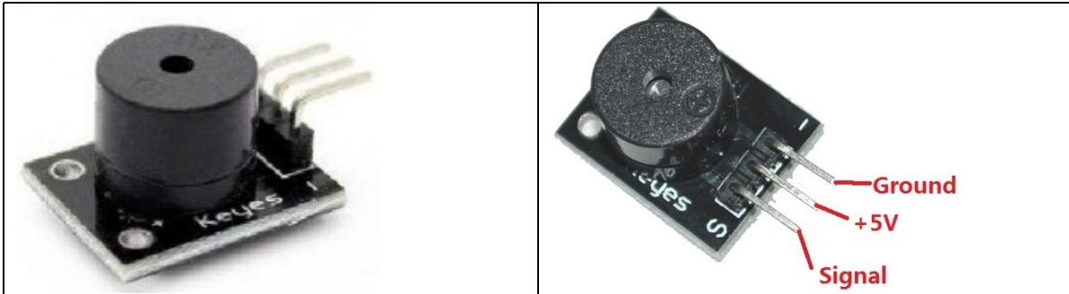
Este módulo te permitirá generar de forma fácil, rápida y precisa vibraciones sonoras. Ya que este Buzzer o zumbador pasivo te permitirá generar diversos sonidos básicos en diferentes frecuencias, gracias a una función integrada en la estructura del mismo, por ello te será muy útil como alarma o para hacer música y sonidos como los que escuchabas en las primeras consolas de video.
