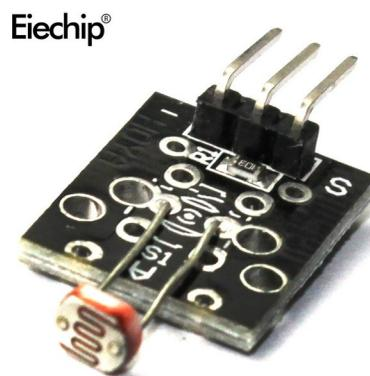
*Las LDR (Light-Dependent Resistor) son resistencias cuyo valor resistivo (Ohmios) varía en función de la luz que incide sobre ellas. Esto las hace especialmente útiles cuando deseas realizar un proyecto que depende de la luz ambiente. Sin embargo, esta no es la única utilidad que le puedes dar a tus LDR con Arduino. Las LDR no solo se ven afectadas por la luz visible. Su valor resistivo también varía con la luz infrarroja y ultravioleta.*
