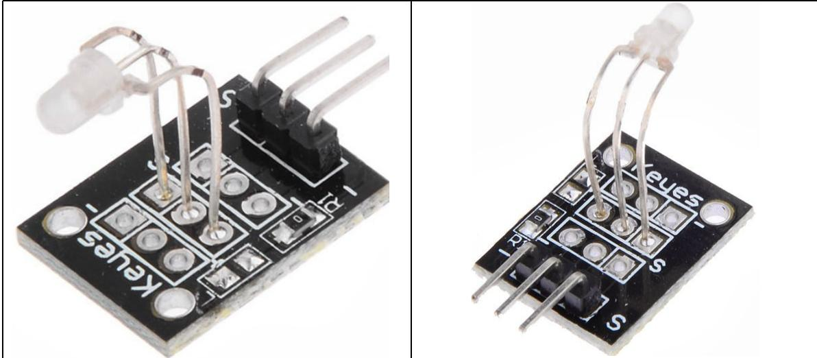
**IMPORTANTE: OBSERVE SIEMPRE SI SU MODULO KEYES TIENE O NO LAS RESISTENCIAS PARA LOS LEDS ROJO Y VERDE.**
