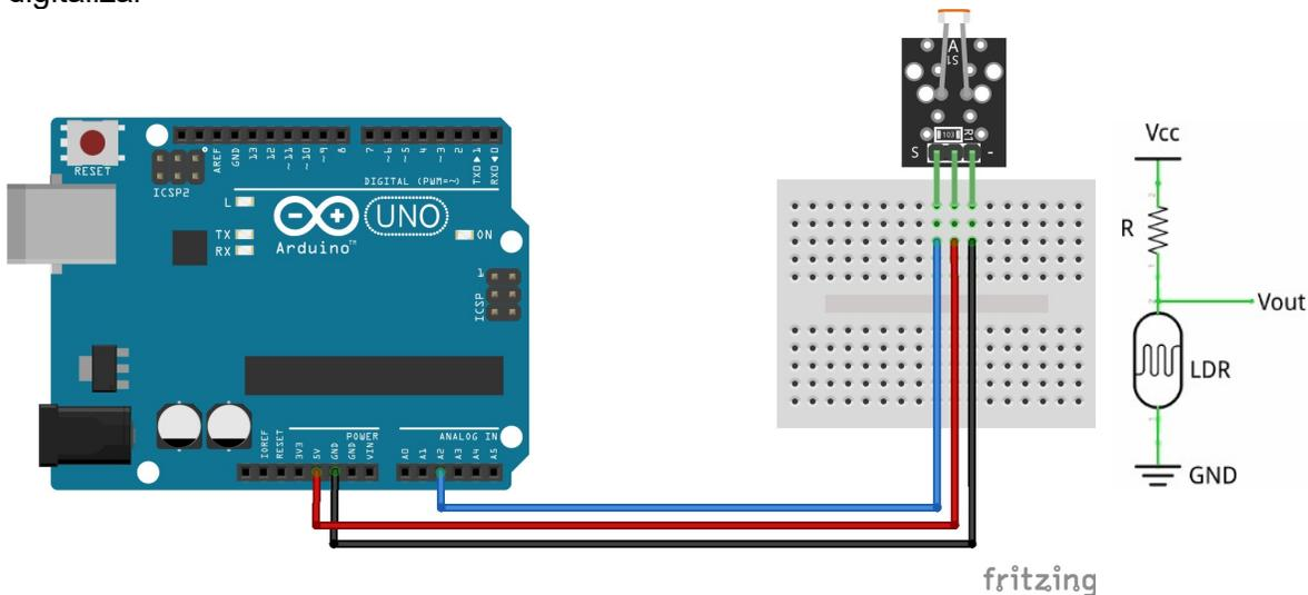
Un código: El siguiente sketch utiliza un LDR para controlar la frecuencia de parpadeo de un LED. Pero notemos que así conectado, cuando la luz sube la resistencia del LDR disminuye por lo tanto cae menos tensión sobre el sensor (recuerde que  $V_{CC} = V_R + V_{LDR}$ ). Por lo cual en oscuridad parpadea más lento el LED y con más luz parpadea más rápido.
