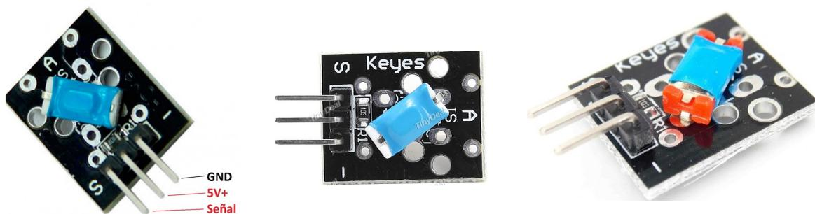
Este módulo está especialmente diseñado para Arduino y te permitirá detectar inclinaciones de cualquier objeto unido estratégicamente al módulo ya que este interruptor de inclinación envía un pulso al detectar una inclinación. Entregando una salida en 1 al percibirse una inclinación por parte del sensor y de 0 en caso de no detectar nada.
