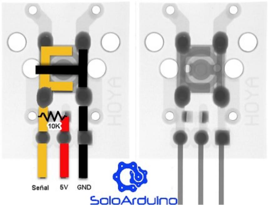
Pulsador en módulo preparado con resistencia pull down en el propio módulo, con esto se evita tener que soldar una resistencia para utilizar el pulsador de manera limpia, ya que la resistencia elimina el ruido eléctrico y evita falsos estados (falsos niveles altos o bajos).
