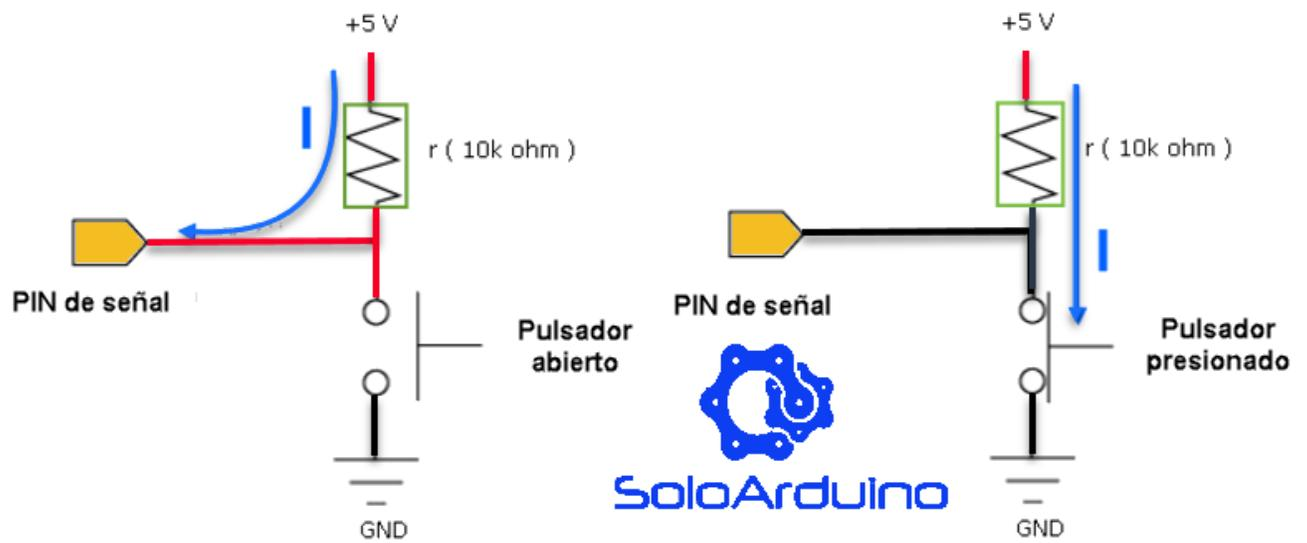
Se podría decir que normalmente se llaman resistencias pull up a resistencias que en general se conectan entre una señal lógica y el positivo y su función es asegurar que esa señal no quede en un estado “flotante”.
