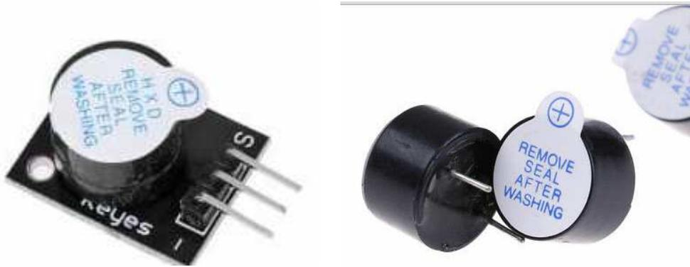
El Módulo de zumbador activo Módulo Arduino **KY-012**, produce un sonido de un tono cuando la señal es alta.
