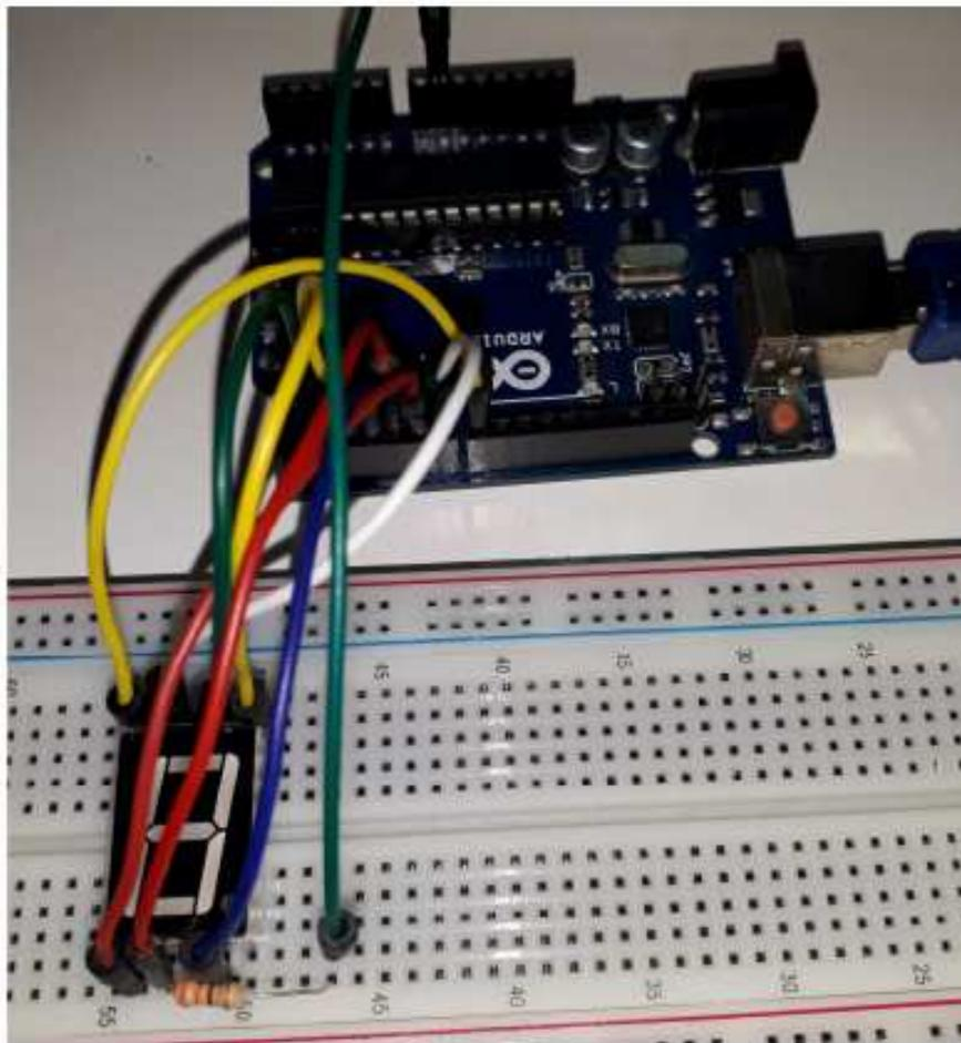
La única resistencia podría rondar los valores de 330 ohms 220 ohms o 100 ohms va en el terminal común. Luego cada segmento va a una salida digital de Arduino. Según corresponda un "0" o un "1" va a encender la barrita correspondiente.
