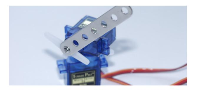
Un servomotor, también llamado servo, es un dispositivo similar a un motor de corriente continua que tiene la capacidad de ubicarse en cualquier posición dentro de su rango de operación, y mantenerse estable en dicha posición.
