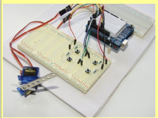
Con dos servos vamos a conseguir dos movimientos principales, uno sobre el plano horizontal y otro en un plano vertical. Podremos mover el «Brazo robótico» hacia izquierda y derecha, y arriba y abajo. Código Arduino para controlar servos con pulsadores
