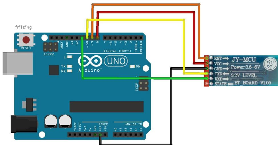
En primer lugar, para que el HC-05 entre en modo comandos AT, requiere que cuando se enciende el modulo, el pin KEY este HIGH. Por eso hemos conectado la tensión Vcc del módulo BlueTooth al pin 8 de nuestro Arduino.
