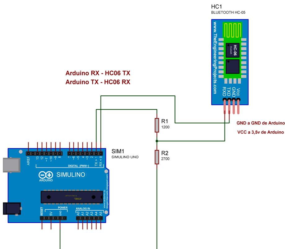
La conexión sería la siguiente entre el modulo Bluetooth HC 05 (valido también para el HC-06) y la placa Arduino:
