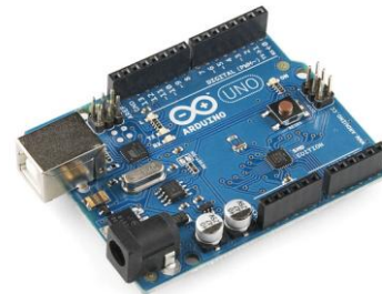
Arduino UNO con microcontrolador en formato SMD
