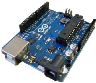
Arduino UNO con microcontrolador en formato DIP
