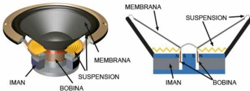
Al hacer circular una corriente por la bobina el campo magnético resultante genera una atracción con el imán, haciendo vibrar la membrana.
