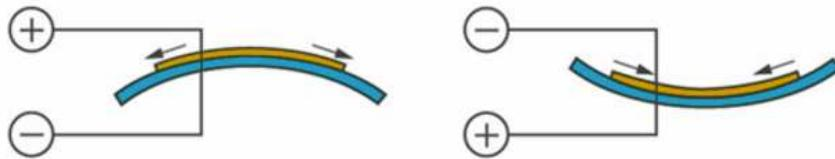
Un buzzer aprovecha este fenómeno para hacer vibrar una membrana al atravesar el material piezoeléctrico con una señal eléctrica.
