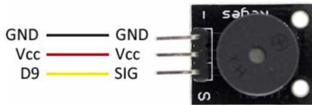
Mientras que el esquema de conexión visto desde Arduino quedaría así
