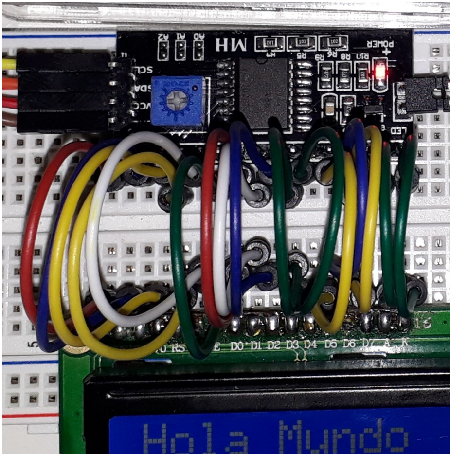
La conexión del modulo I2C al LCD es una a una.
