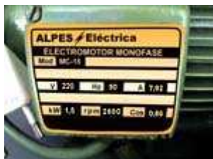
Placa colocada al costado de un motor monofásico de corriente alterna, donde aparece, entre otros datos, su potencia en kilowatt (kW), o en C.V. (H.P.).
