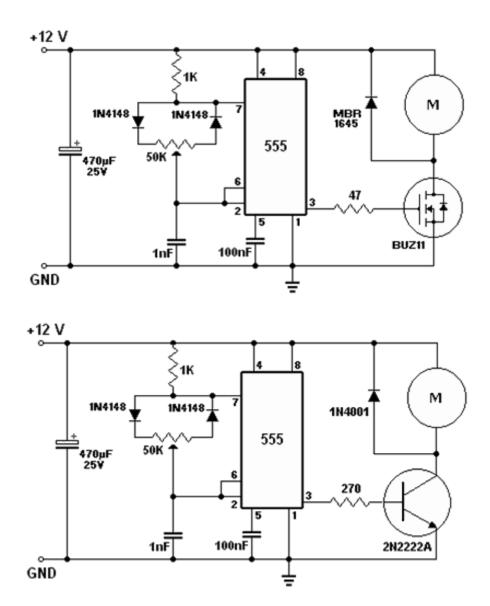
En ambos circuitos podemos notar las siguientes características, el capacitor de 470uf tiene la función de bypass, es decir el motor produce fluctuaciones en la tensión de la alimentación cuando funciona, estas fluctuaciones afectan a la electrónica de control (555), el capacitor tendería a disminuir esas fluctuaciones. Si esto no lo soluciona, se debería pensar una alimentación alternativa para el motor.
