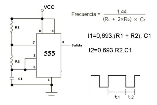
Podríamos imaginar que **R2** la reemplazamos con un potenciómetro (descartamos la influencia de los diodos)
