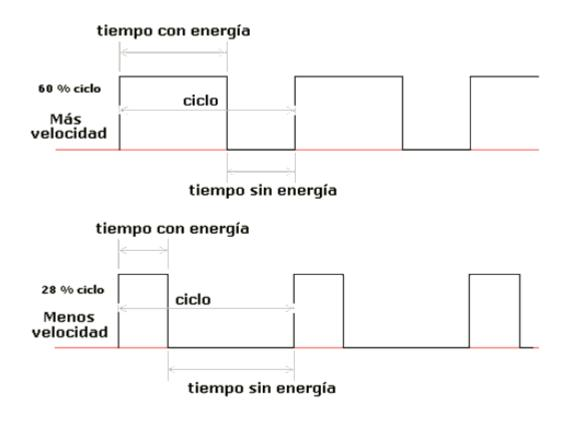
Estas señales se envían al motor a una determinada frecuencia. El resultado final del proceso de PWM es que la potencia total enviada al motor se puede ajustar desde x % ciclo de trabajo a casi 100% del ciclo de trabajo) con un buen rendimiento y un control estable.
