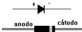
Figura 8 : Marcación de Polaridad en los diodos
