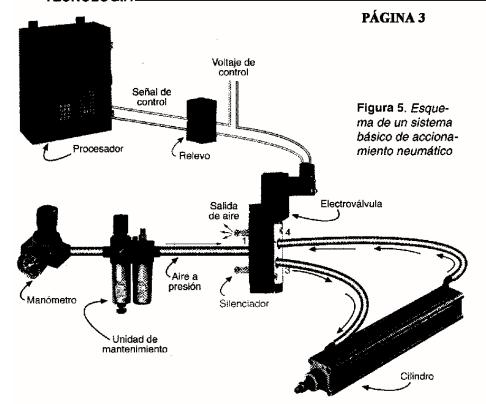
Manómetros. Son instrumentos de medición que nos indican la presión que posee el aire que está pasando por el punto donde este ha sido instalado. La presión del aire, está dada en bares o en psi (libras por pulgada) y es normal en una planta, encontrar la presión del aire de suministro general en 5 ó 6 bares.
