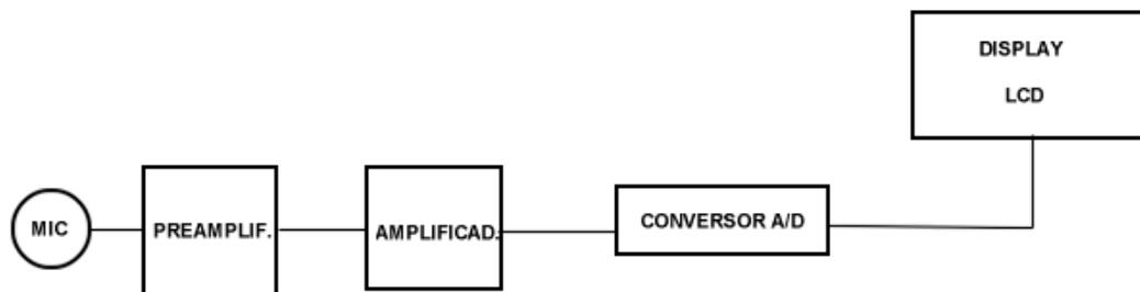
En esencia, consta de un micrófono, un preamplificador, un amplificador una sección de procesamiento de señal y una unidad de lectura.
