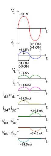
Durante el semiciclo positivo de la tensión de la red, los diodos  $D_1$  y  $D_3$  conducen, esto da lugar a un semiciclo positivo en la resistencia de carga.
