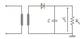
Primeramente vamos a ver ese circuito sin C. En este caso la forma de onda de la intensidad es igual a la tensión en la resistencia.
