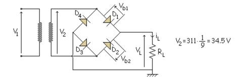
Mediante el uso de 4 diodos en vez de 2, este diseño elimina la necesidad de la conexión intermedia del secundario del transformador. La ventaja de no usar dicha conexión es que la tensión en la carga rectificada es el doble que la que se obtendría con el rectificador de onda completa con 2 diodos.
