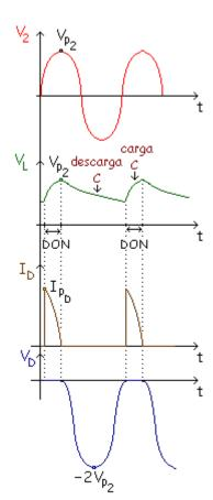
Mientras el C se carga D conduce (D ON) y mientras C se descarga D no conduce (D OFF).
