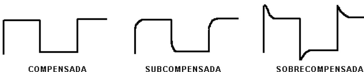
Si la punta muestra que no está compensada se deberá proceder a compensarla, para ello tiene un capacitor variable en uno de sus extremos, que con un pequeño destornillador podemos girar hasta obtener la perfecta onda cuadrada.
