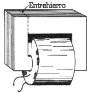
También supóngase que la densidad de flujo sin núcleo (núcleo de aire) es de 50 líneas por pulgada cuadrada. La relación entre estas dos densidades de flujo, hierro a aire, es  $40.000/50 = 800$ . Esto se llama permeabilidad del núcleo.
