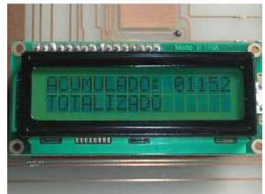
Los pines de conexión de estos módulos incluyen un bus de datos de 8 bits, un pin de habilitación (E), un pin de selección que indica si lo que se esta enviando por el bus es un dato o una instrucción (RS) y un pin que indica si se va a leer o escribir en el módulo (R/W). La tabla a continuación describe en detalle los pines mencionados.
