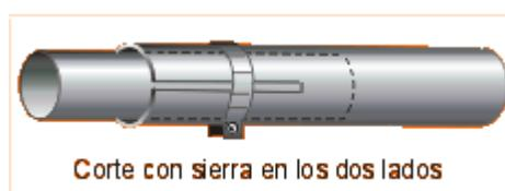
El último tubo de la antena deberá ser extensible respecto a los precedentes de modo que se pueda variar la longitud de la antena hasta eliminar completamente toda onda estacionaria.
