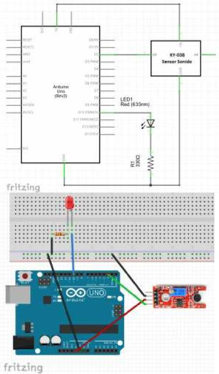
Si hemos conectado bien el sensor, se debería iluminar el LED de alimentación. El de salida digital accionada puede o no estar encendido.
