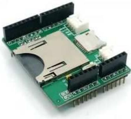
En este otro ejemplo mostramos una SD Card para Arduino que tenemos que conectar manualmente, como se muestra en la imagen:
