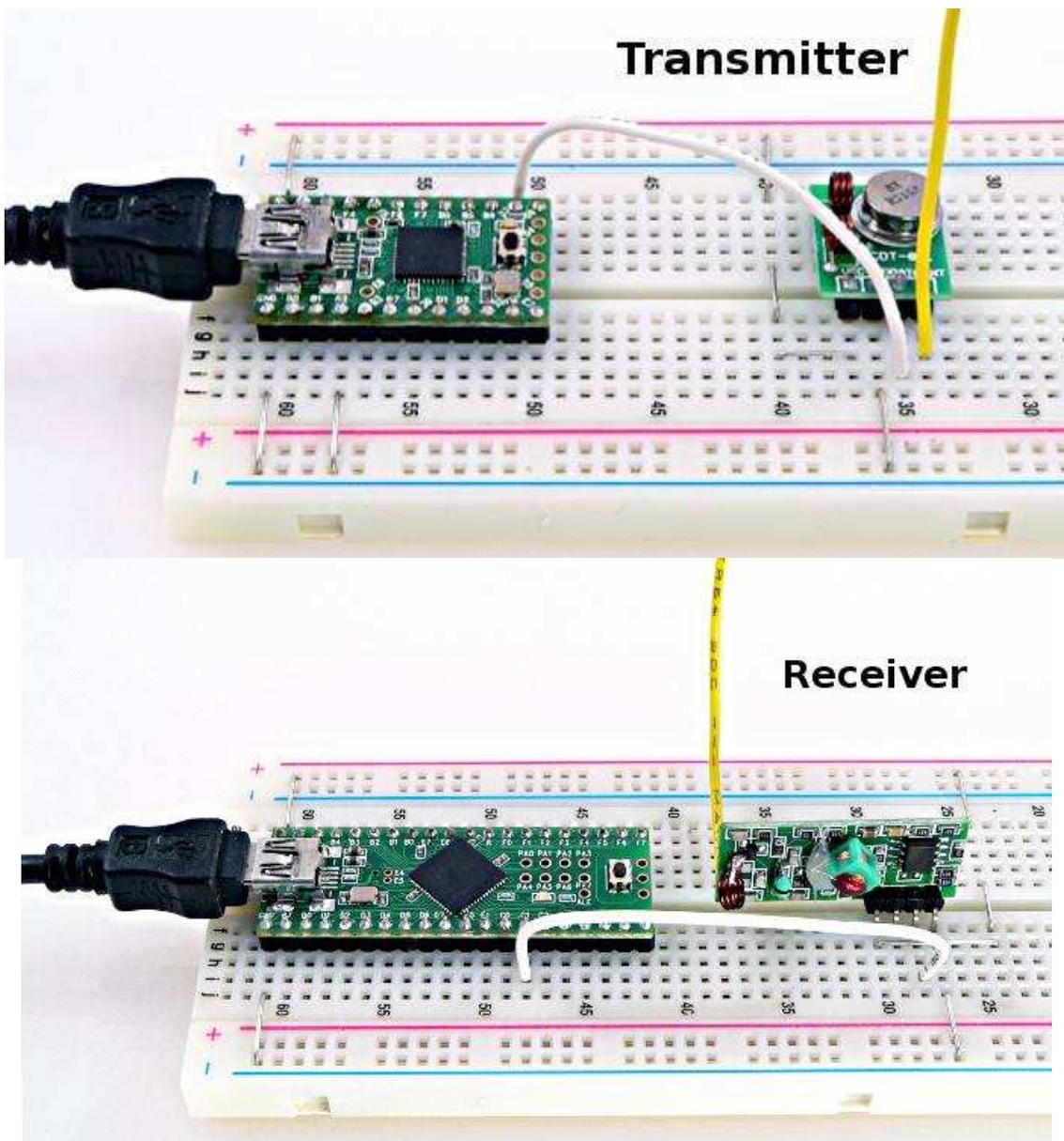
Estos módulos de bajo costo son muy simples. La señal de salida del receptor indica si se escucha la energía de un transmisor. Puede ser conectado a cualquier perno, pero no puede conducir los pernos con un LED atado.
