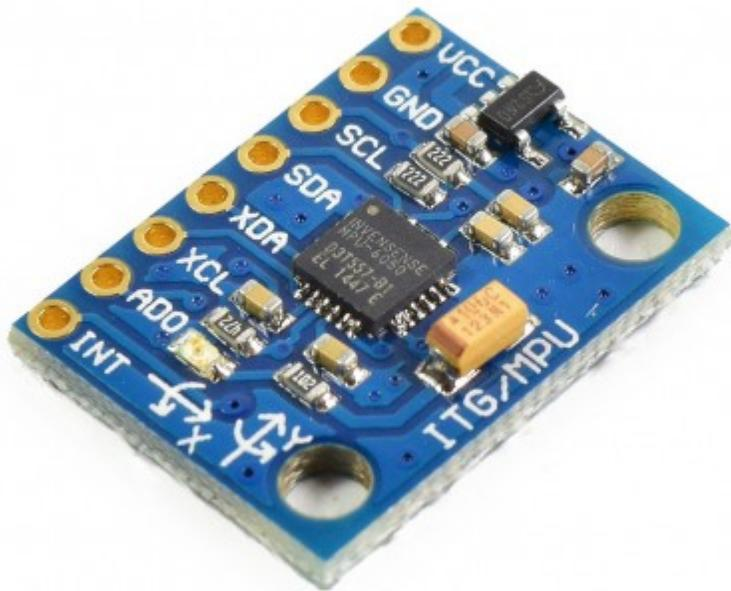
EL módulo Acelerómetro MPU tiene un giroscopio de tres ejes con el que podemos medir velocidad angular y un acelerómetro también de 3 ejes con el que medimos los componentes X, Y y Z de la aceleración.
