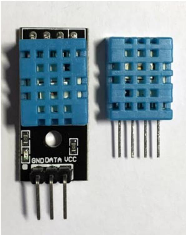
Podemos encontrar el DHT11 de dos maneras diferentes. Por un lado el sensor solo, sin la resistencia pull-up (5 K $\Omega$  según las especificaciones técnicas) necesaria para evitar inestabilidades en la señal de salida, por menos de 1,5 €. Por otro lado un circuito integrado que tiene todo lo necesario para conectar y funcionar por un poco menos de 2€. Merece la pena comprar este último debido a que ya tenemos todo montado y nos podemos olvidar de los componentes extra.
