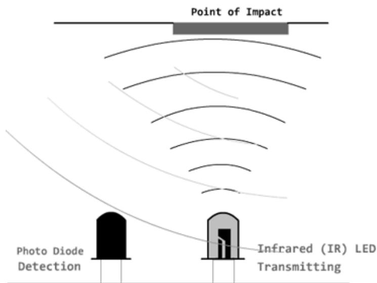
Los detectores de obstáculo suelen proporcionarse con una placa de medición estándar con el comparador LM393, que **permite obtener la lectura como un valor digital** cuando se supera un cierto umbral, que se regula a través de un potenciómetro ubicado en la placa.
