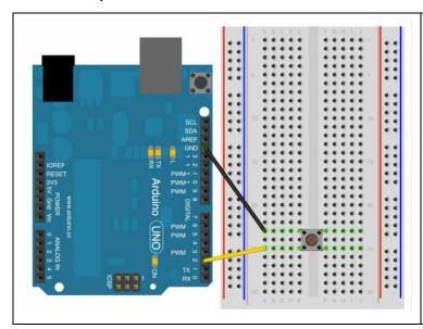
Donde se ha colocado un pulsador sin resistencia externa de PULLUP, ya que se usa la interna de Arduino.
