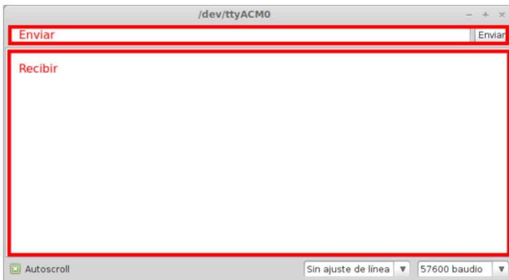
Pese a su sencillez este monitor de puerto serie es suficiente para los ejemplos de esta entrada, y resulta muy útil para realizar test o experimentos rápidos.
