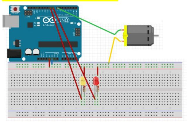
Si conectas el motor sin un puente h, u otro driver de corriente, pueden pasar un par de cosas:
