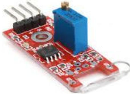
Este módulo cuenta con una lámina detectora de campos magnéticos (Reed Switch) y un LED el cual deberá conectarse al pin 13 del Arduino, al detectar un campo el LED se encenderá y de esta manera generara una alerta. De no detectar ningún campo el LED permanecerá apagado.
