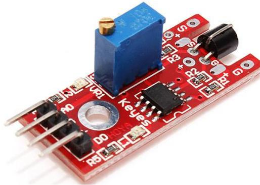
Módulo sensor metálico táctil, cuenta con un LED que deberá conectarse con un simple circuito al pin número 13 del Arduino. Cuando el sensor detecta un el toque de una persona el LED conectado deberá encender, de lo contrario el LED permanecerá apagado.
