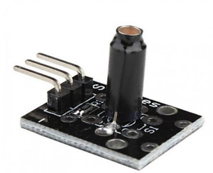
Este módulo sensor de vibraciones funciona como un Switch, al detectar una vibración cierra un circuito lo que genera que el usuario pueda detectar los movimientos. El modulo debe conectarse el PIN 10 del Arduino. Cuando detecta una vibración se enciende el LED conectado al PIN 13.
