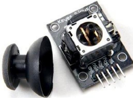
Joystick similar al incluido en el juego PS2, el joystick por un potenciómetro en cada eje que es variado con los movimientos, además, incluye un botón Z que es activado al presionar el joystick.
