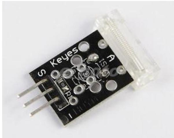
El modulo sensor de golpe debe ser conectado a un circuito muy simple que constara de un LED conectado al PIN 13 del Arduino, el cual, parpadeara en el momento que el modulo detecte un golpe, de lo contrario el LED permanecerá encendido.
