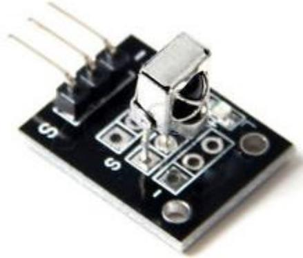
Este es el nuevo y ultra delgado 38k infrarrojo para control remoto universal, utilizado en la codificación NEC, principalmente en vehículos con MP3, marco de fotos digital, iluminación equipada y otras aplicaciones. Debido a que es no lineal es de fácil uso y aprendizaje de parte del usuario.
