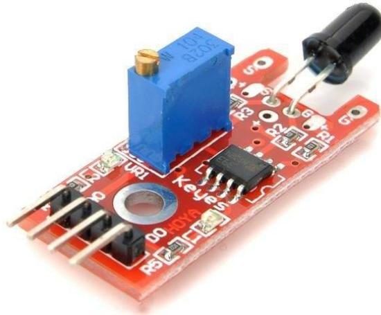
El sensor funciona entre las longitudes de onda infrarroja 760 nm a 1100 nm, es más sensible utilizando dos salidas a 60 grados. Salida analógica: señal analógica de tensión conectada a una resistencia térmica. Señal digital: cuando la temperatura alcanza ciertos umbrales la salida del sensor sube y baja en conjunto con la temperatura, esta señal a la salida es variable con el potenciómetro.
