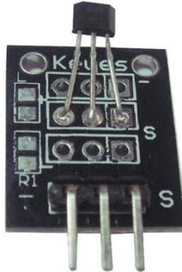
Módulo sensor magnético analógico, se debe construir un circuito simple con un LED para crear un campo magnético Makers. Cuando el sensor detecta un campo magnético el LED conectado deberá encender, de lo contrario el LED permanecerá apagado.
