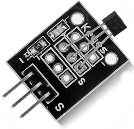
Este sensor mide un campo magnético. Si existe la presencia de un campo magnético se creara una señal en alto. En este ejemplo, el LED de la placa Arduino (pin 13) se enciende cuando la señal del sensor es alta. También el LED propio del módulo se enciende cuando la señal esta en alto.
