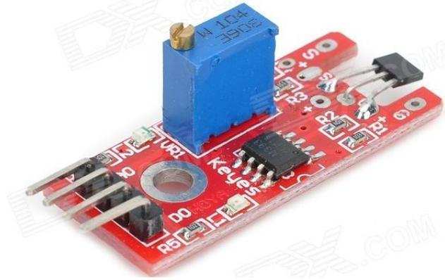
Este módulo cuenta con un sensor de campo magnético y un LED el cual deberá conectarse al pin 13 del Arduino, al detectar un campo el LED se encenderá y de esta manera generara una alerta. De no detectar ningún campo el LED permanecerá apagado.
