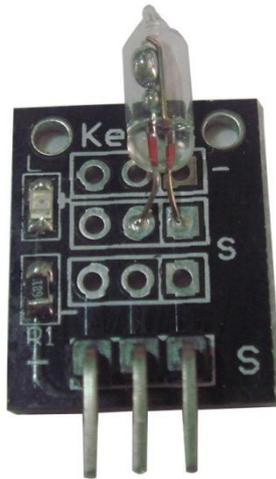
El modulo óptico de mercurio es utilizado para detectar inclinación y encendiendo un LED informa al usuario, este sensor es el precursor de los ahora llamados acelerómetros utilizados en los dispositivos móviles como celulares inteligentes y tabletas.
