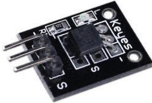
Los Arduino tienen un gran número de usos, uno de ellos es la medición de la temperatura, en este caso usaremos un sensor DS18B20, el cual está integrado en este módulo y además es uno de los más usados en el mundo.
