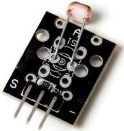
Este módulo contiene una fotorresistencia, la cual es una resistencia variable dependiente de la cantidad de luz en su entorno. En la oscuridad, su resistencia es muy alta, a veces hasta 1 M $\Omega$ , pero cuando el sensor LDR se expone a la luz, la resistencia se reduce drásticamente, incluso a unos pocos ohm, dependiendo de la intensidad de la luz.
