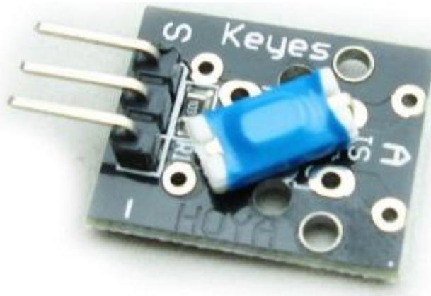
Módulo interruptor de inclinación, este sensor envía un pulso al detectar una inclinación. Se mostrara un código ejemplo en el cual será necesario construir un circuito simple que contara de un LED, dicho LED encenderá al percibirse una inclinación por parte del sensor, de no detectar nada, el LED permanecerá apagado.
