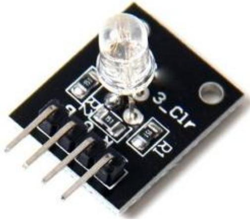
Este módulo consta de un LED capaz de encender en cualquier color por medio de la mezcla de los colores del sistema RGB (rojo, verde y azul), esto con el fin de lograr muchas combinaciones posibles y lograr efectos muy colorido y llamativos.
