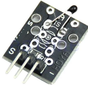
El modulo contiene un termistor (resistencia que varía según la temperatura del ambiente), censa en tiempo real la temperatura y varia sus valores internos, conectando al Arduino en sus pines analógicos es posible realizar un gran número de implementaciones, por ejemplo, alamar térmicas.
