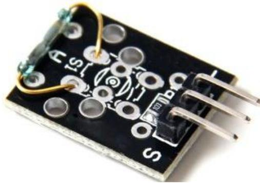
Una lámina magnética es un sensor que se encuentra comúnmente abierto y al detectar un campo magnético se cierra, permitiendo el paso del voltaje.
