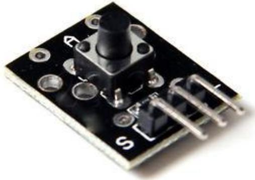
Este módulo tiene integrado un interruptor común, se muestra un ejemplo en el cual, al presionar el botón se encenderá el LED conectado al PIN 13 del Arduino.
