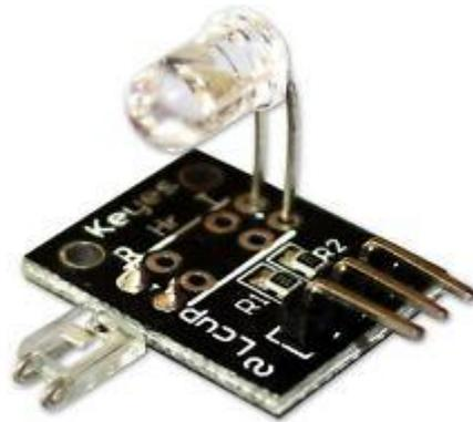
Este módulo utiliza un LED infrarrojo brillante y un fototransistor para detectar el pulso del dedo, el LED enciende en rojo con cada pulso. Monitor de pulso funciona de la siguiente manera: El LED genera la luz por un lado del dedo, y el fototransistor en el otro lado del dedo, el fototransistor es utilizado para obtener el flujo emitido, cuando el pulso de la presión arterial en el dedo varia la resistencia del fototransistor cambia ligeramente.
