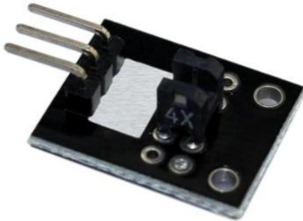
Modulo foto-interruptor que funciona con Arduino. Si el sensor es accionado entonces el LED se enciende.
