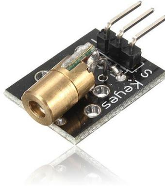
Este módulo tiene integrado un transmisor laser y una interfaz digital, además cuenta con un LED incorporado.
