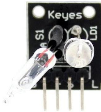
Este módulo tiene dos partes - un LED y un interruptor de inclinación de mercurio.
