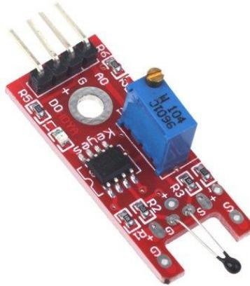
Módulo de temperatura digital, cuenta con un LED que se conecta al PIN 13 del Arduino. El sensor de temperatura digital es activado al detectar una variación en la temperatura, cuando esto sucede el LED se enciende, de lo contrario el LED permanecerá apagado.
