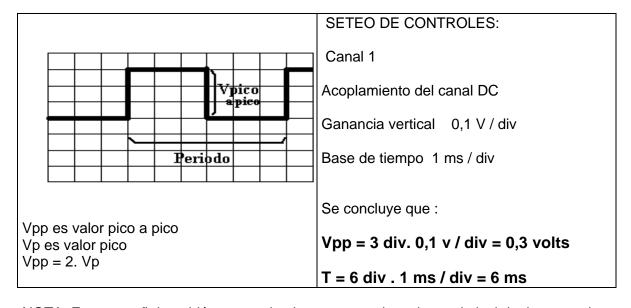
NOTA: En esta señal también se puede observar que si se ajusta el nivel de tierra en el centro de la pantalla, entonces esta señal contiene una componente continua que es la causa de su desplazamiento por encima del eje de tierra.
