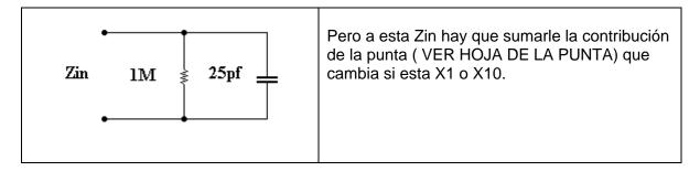
Las masas (tierra) de los canales están conectadas internamente en el OSC del laboratorio. Esto hay que tenerlo en cuenta porque al querer visualizar 2 señales de un mismo circuito, usando ambos canales (DUAL) podría suceder que cortocircuitemos alguna parte del circuito que se esta midiendo.
