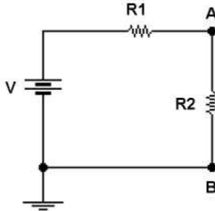
Podemos ir probando valores para R1 y R2 hasta obtener lo pedido. El enunciado pide además que las potencias no superen el 1/4 de Watt.
